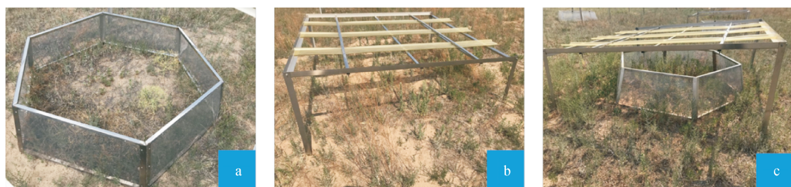
a. 增温装置; b. 降水减少装置; c. 增温×降水减少装置
