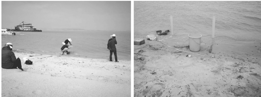
图 4 野外现场竖管法测定研究区沉积物渗透系数
