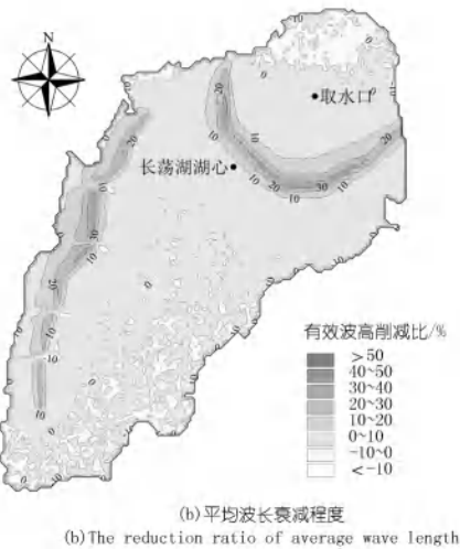
图 4 方案 1 地形下有效波高和平均波长削减程度
