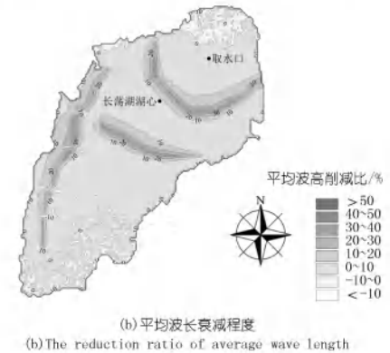
图 6 方案 3 地形下有效波高和平均波长削减程度
