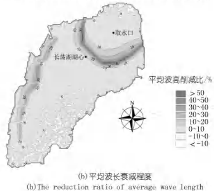
图 5 方案 2 地形下有效波高和平均波长削减程度
